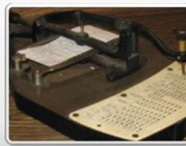
La tarjeta perforada o simplemente tarjeta es una lámina hecha de cartulina que contiene información en forma de perforaciones según un código binario. Estos fueron los primeros medios utilizados
