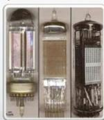
El selectrón es una válvula termoiónica capaz de actuar como memoria de acceso aleatorio (RAM), diseñada por RCA en 1946, pero que no estuvo disponible comercialmente hasta la primavera de 1948.
